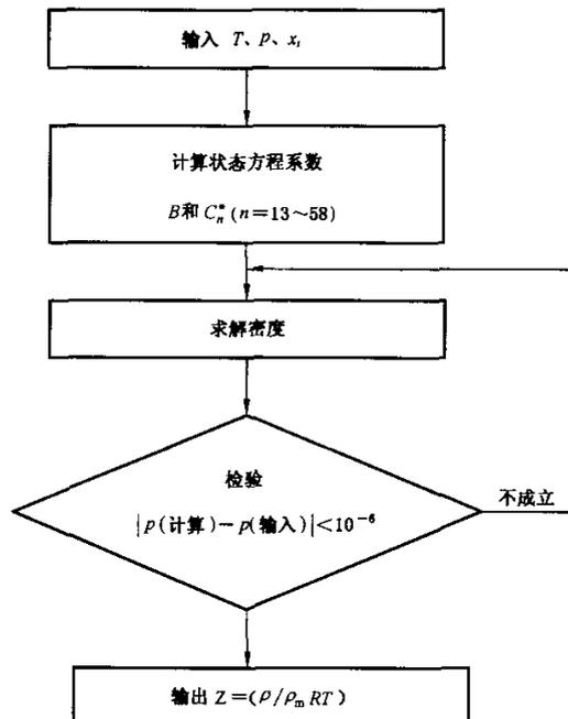
图 B.1 AGA8-92DC 计算方法的程序流程图
