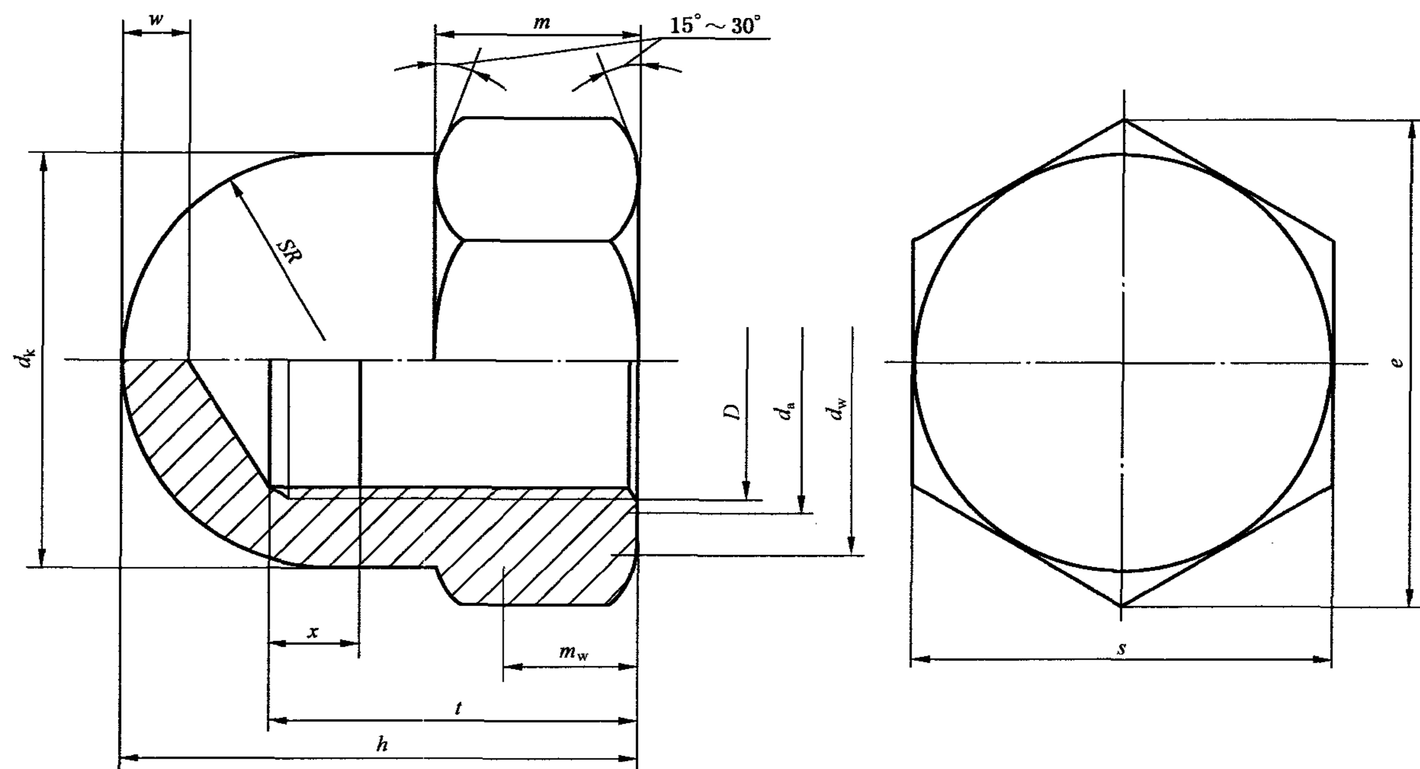
图 1  $D \leq 10 \text{ mm}$  盖形螺母的型式与尺寸
